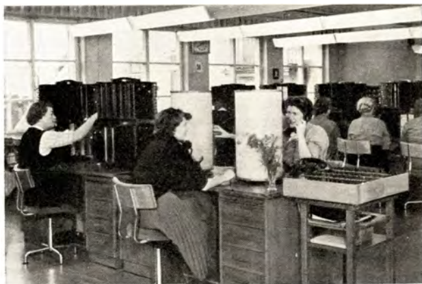
Nimitiedotus ja muutokset. Vasemmalla näkyvistä flexorummuista saadaan vastaus kysymykseen »kenellä on numero — —». Oikealla olevista valkoisista rummuista saa tiedon »numero on muuttunut, olkaa hyvä ottakaa numero — —»
