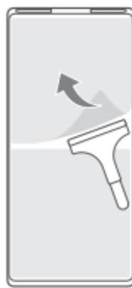
5. Suihkuta liimanpoistoainetta lasiin ja kiinnikkeessä olevaan liimaan. Odota 1–2 minuuttia ja poista jäänökset kaavinveitsellä ja pyyhkeellä.
