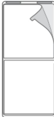
4. Setze die Halterung an der Stelle an, die du gereinigt hast, und drücke die Halterung von oben nach unten mindestens 30 Sekunden lang mit einem Druck von mindestens 15 PSI ( $1 \text{ kg/cm}^2$ ) fest und gleichmäßig an. Überprüfe die Luftblasen von der anderen Seite des Glases aus, und vergewissere dich, dass die Halterung vollständig am Glas befestigt ist. Entferne oder betaste den Kleber nicht, da dies die Klebekraft beeinträchtigen kann.
