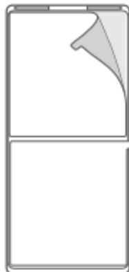
4. Fissare la staffa all'area pulita e premere la staffa dall'alto verso il basso in modo deciso e uniforme con una pressione di almeno 15 PSI ( $1 \text{ kg/cm}^2$ ) per 30 secondi o più. Controllare le bolle dall'altro lato del vetro e assicurarsi che la staffa sia completamente fissata al vetro. Non rimuovere o toccare l'adesivo per non compromettere la forza adesiva.
