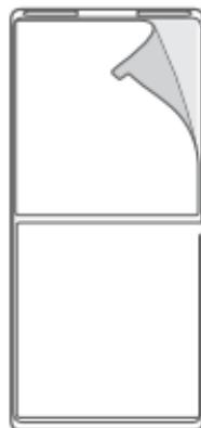
4. Kiinnitää kiinnike puhdistamaasi kohtaan ja paina kiinnikettä ylhäältä alas voimakkaasti ja tasaisesti vähintään 15 PSI:n ( $1 \text{ kg/cm}^2$ ) paineella vähintään 30 sekunnin ajan. Tarkista ilmakuplien varalta lasin toiselta puolelta ja varmista, että kiinnike on täysin kiinni lasissa. Älä poista tai kosketa liimaa, sillä se voi heikentää liimaustehoa.
