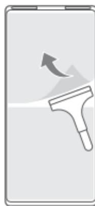
5. Sprühe Klebstoffentferner auf das Glas und den Kleber auf der Halterung. Warte 1 bis 2 Minuten und entferne die Rückstände mit dem Spachtelmesser und einem Handtuch.
