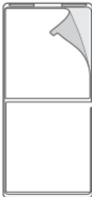
4. Fest braketten til området du har rengjort og trykk braketten fra topp til bunn hardt og jevnt med et trykk på minst 15 PSI ( $1 \text{ kg/cm}^2$ ) i 30 sekunder eller lenger. Kontroller boblene fra den andre siden av glasset, og sørг for at braketten er helt festet til glasset. Ikke fjern eller berør limet, siden dette kan svekke limkraften.
