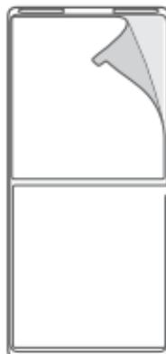
4. Bevestig de beugel op het gebied dat u hebt schoongemaakt en druk de beugel van boven naar beneden hard en gelijkmataig aan met een druk van ten minste 15 psi ( $1 \text{ kg/cm}^2$ ) gedurende 30 seconden of langer. Controleer op luchtbellen aan de andere kant van het glas en zorg ervoor dat de beugel volledig tegen het glas is bevestigd. Verwijder of raak de lijm niet aan, omdat hierdoor de kleefkracht kan afnemen.
