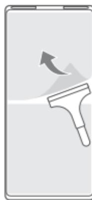
5. Spruzzare il solvente per adesivi sul vetro e sull'adesivo sulla staffa. Attendere 1 o 2 minuti e rimuovere i residui con il raschiavetro e l'asciugamano.
