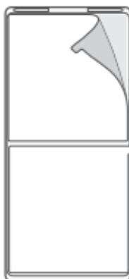
4. Pritvirtinkite laikiklį toje vietoje, kurią nuvalėte ir 30 sekundžių ar ilgiau stipriai ir tolygiai spauskite laikiklį iš viršaus į apačią ne mažesniu kaip 15 PSI ( $1 \text{ kg/cm}^2$ ) slėgiu. Patikrinkite, ar nėra oro burbuliukų iš kitos stiklo pusės ir įsitikinkite, kad laikiklis visiškai pritvirtintas prie stiklo. Nenuimkite ir nelieskite klijų, nes tai gali susilpninti sukibimo jėgą.
