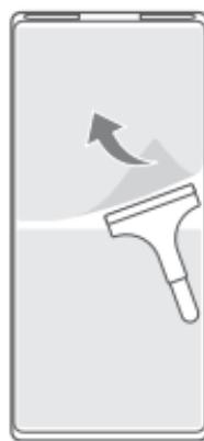
5. Spuit lijmverwijdering op het glas en de lijm op de beugel. Wacht 1 tot 2 minuten en verwijder de resten met het schraapmes en de handdoek.
